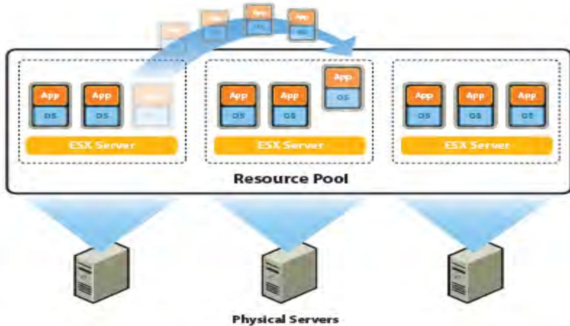
**VMware DRS** ermöglicht einen dynamischen Ausgleich der Computing-Kapazitäten für Hardwareressourcen, die in logischen Ressourcenpools zusammengefasst sind. Dabei überwacht VMware DRS kontinuierlich die Auslastung dieser Pools und sorgt für eine intelligente Zuweisung der verfügbaren Ressourcen zu den virtuellen Maschinen.
